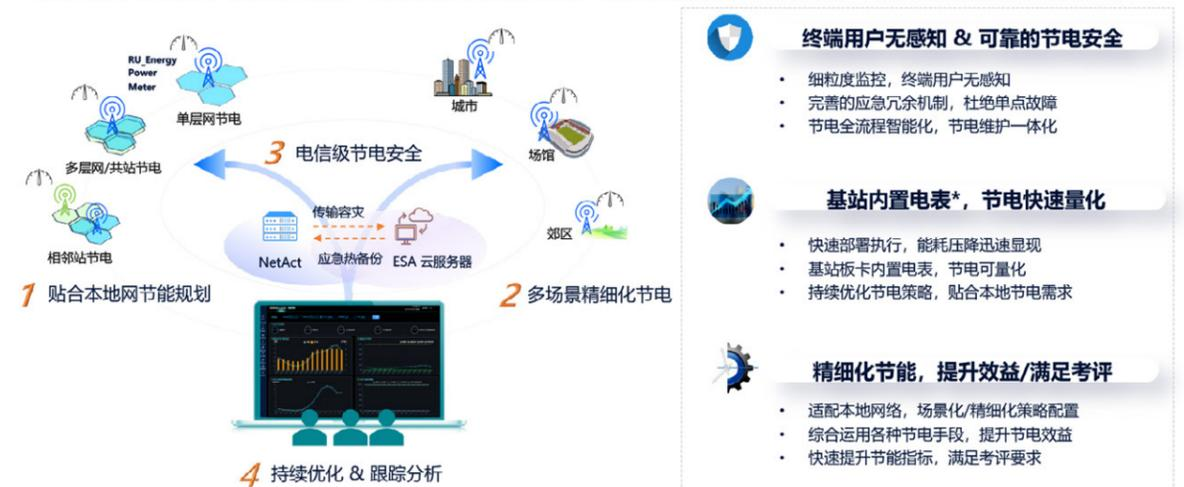
\*基站内置电表指：RU\_ENERGY计数器 (M40003)，挂表实测偏差度<4%
